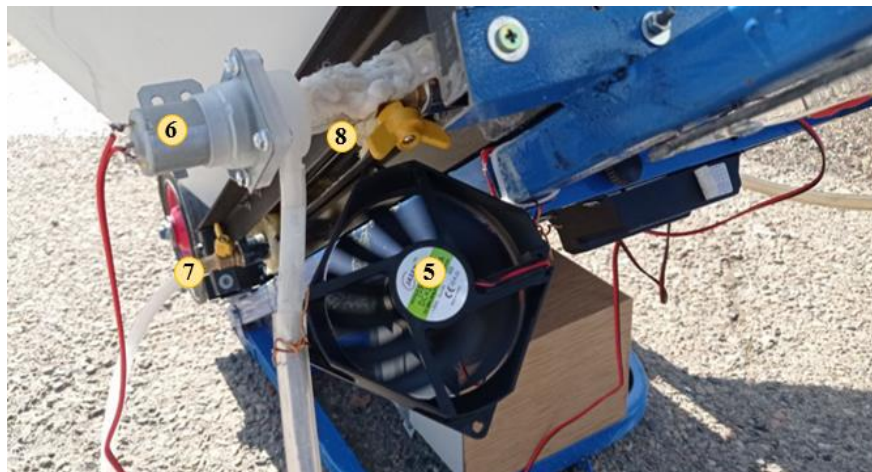
Рисунок 3. Часть мобильной опреснительной установки, которая охлаждает выход пара и сбрасывает собранные капли пара.
