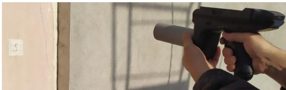
Рисунок 2. Определение фактора направленности со стальным направителем длиной в 15 см
