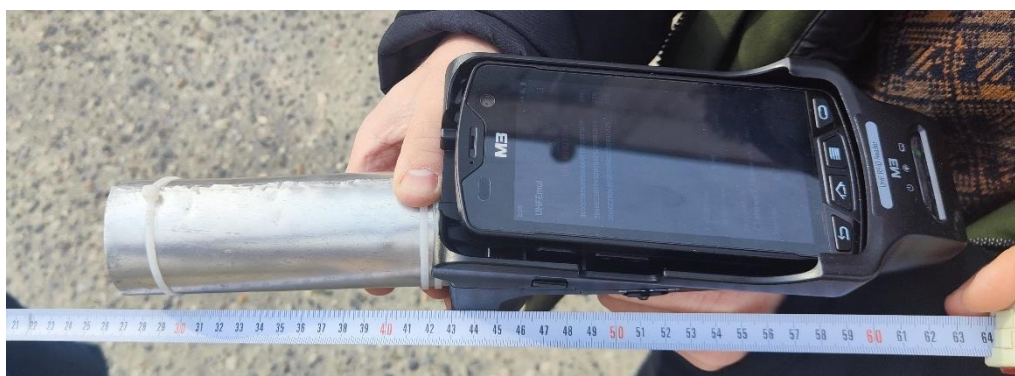
Рисунок 3. Определение фактора направленности с алюминиевым направителем в 30 см
