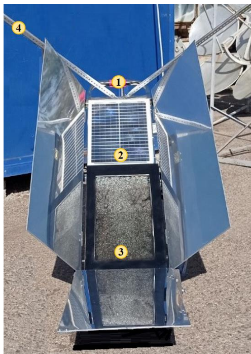
Рисунок 2. Портативная опреснительная установка, вид спереди.
