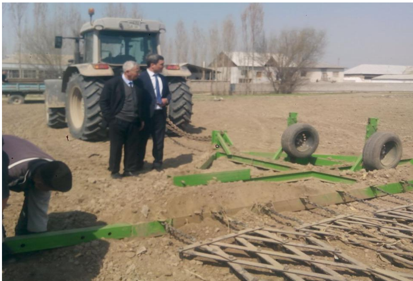
Рис.2. Процесс увеличения ширины захвата с помощью выдвинутых дополнительных боковых секций.
