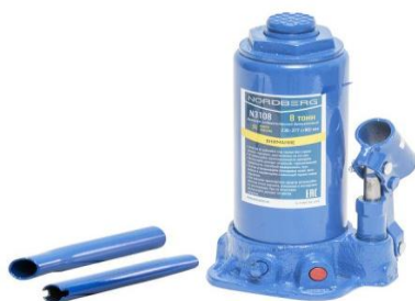
4-rasm. Nordberg N3108 markali silindrsimon gidravlik domkrat. 8 t gacha yukka, avtomobilning tag qismidan ko‘tarishga mo‘ljallagan universal domkrat. Minimal balandligi 230 mm, ishchi holatdagi balandligi 377 mm. Og‘irligi 5,6 kg, Gabarit o‘lchamlari 120x240x130 mm.
