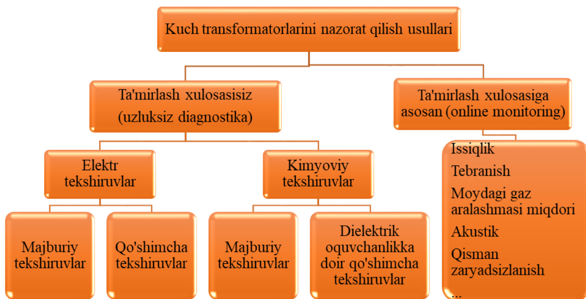
1-rasm. Kuch transformatorlarini nazorat qilishning asosiy usullari [1].
